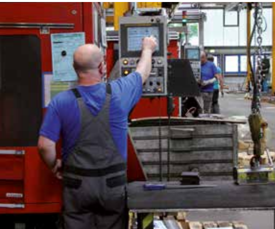
Per Touchscreen werden die gewünschten Parameter an den Fräsmaschinen eingestellt.
