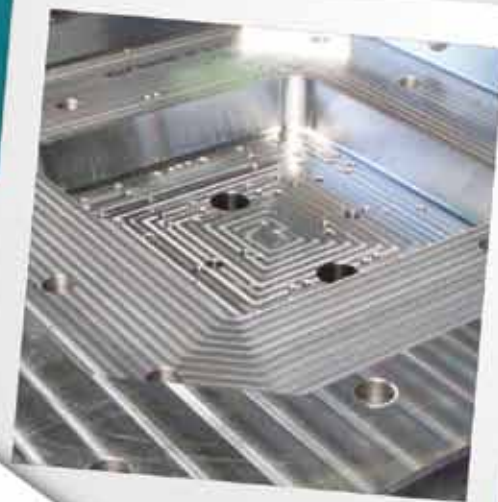
Kunststoffform aus Werkzeugstahl von EschmannStahl
