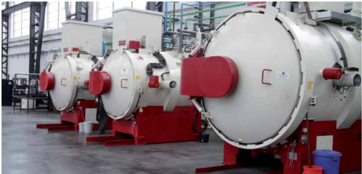
Die erweiterten Kapazitäten mit neuen Härteöfen (im Bild) und Anlassöfen ermöglichen unter anderem kürzere Durchlaufzeiten.
