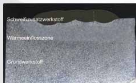
Einlagige Schweißnaht angelassen bei 480 °C
