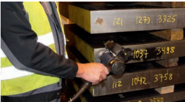
Mit einem mobilen Spectral-Analysegerät überprüft Stefan Lemmer die Qualität des Stahls.
