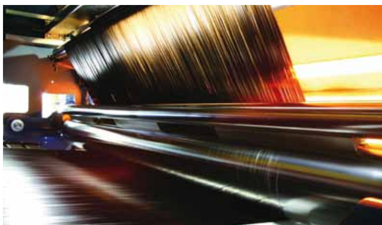
Produktionsanlage für bahnförmiges Carbonmaterial
