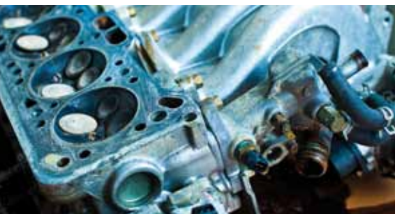
Zylinderblock, hergestellt im Druckgussverfahren
