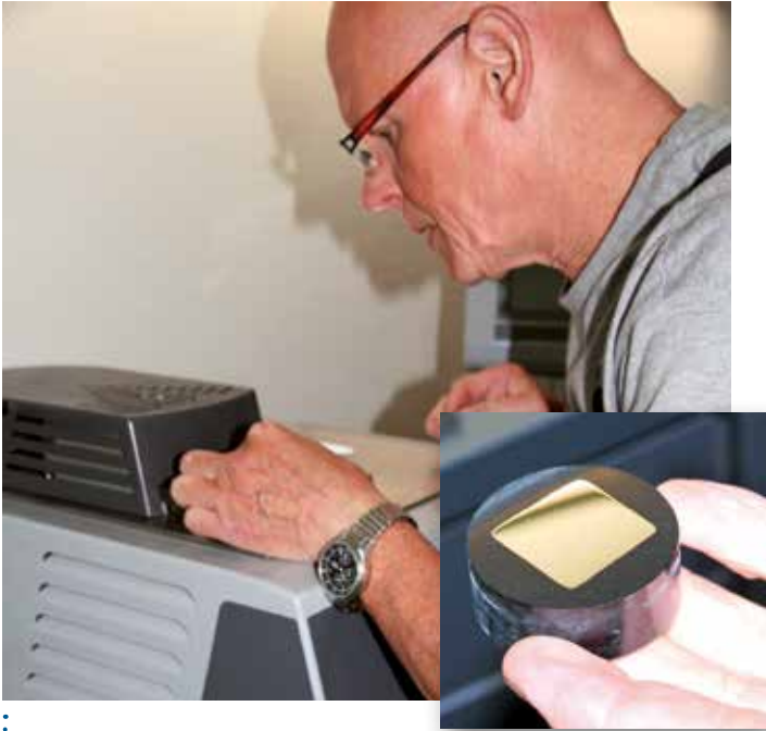
Hartmut Kemper gibt ein zurecht gesägtes Stück Stahl in die Einbettpresse, um damit einen Probekörper herzustellen.
